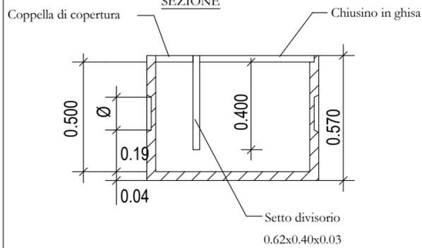
Pozzetto realizzato con elementi prefabbricati in cemento vibrato, munito di impronte laterali per l'immissione di tubi Ø 160, posto in opera su un letto di calcestruzzo R'ck 150 - Sp.= 10 cm. I pozzetti saranno sistemati lungo tutti i tracciati delle fogne di progetto ad un interasse di circa 25.00 mt. da entrambi i lati della sede stradale.
